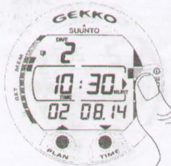
Рис. 4.10 Дневник погружений, вариант 1. Для выбора номера погружения нажимайте кнопку SMART.
