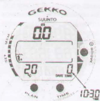
Рис. 3.3 Режим Поверхности: глубина и время погружения равны нулю. Нажатием на кнопку TIME, можно перейти к отображению температуры и текущего времени.
