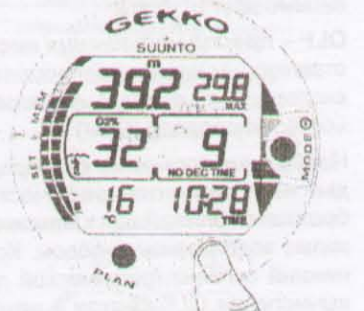
Рис. 3.24 Нажатием на кнопку TIME отображается текущее время, максимальная глубина, температура, CBT и O_2\% .
