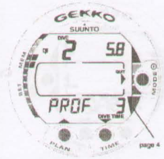
Рис. 4.9 Дневник погружений, вариант 4. Профиль характерного погружения.
