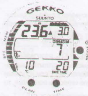
Рис. 3.15 Декомпрессионное погружение, глубина больше глубины «пола». Стрелка, направленная вверх, мигающая надпись ASC TIME и звуковой сигнал напоминают о необходимости всплытия. Минимальное время всплытия 7 минут. Глубина «потолка» 3 метра.
