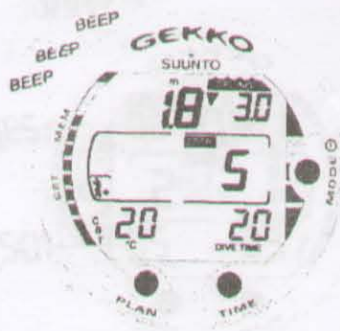
Рис. 3.14 Пропущена Обязательная остановка безопасности.
