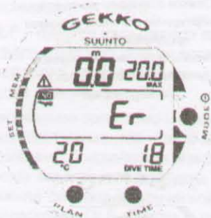
Рис. 3.29 Режим поверхности после пропуска декомпрессионной остановки.
