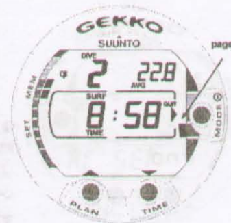
Рис. 4.8 Дневник погружений, вариант 3. Время нахождения на поверхности и средняя глубина.
