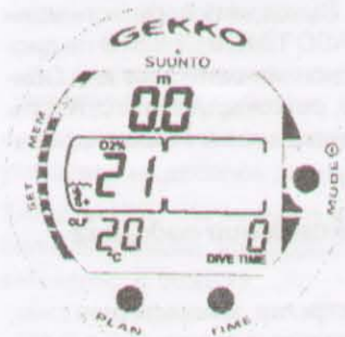
Рис. 3.21 Дисплей при нахождении на поверхности в режиме NITROX.
