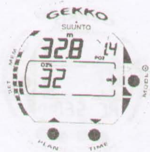
Рис. 4.17 Настройка параметров газовой смеси Nitrox. Содержание кислорода 32%, максимум парциального давления - 1,4 бар. Исходя из этих установок, максимально допустимая глубина погружения - 32,8 м. Для изменения параметров используйте кнопки прокрутки. Подтвердите сделанные изменения нажатием кнопки MODE (OK).
