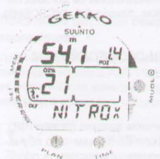
Рис. 3.22 Погружение в режиме NITROX. Значение O_2 - 21%.
