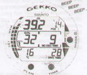
Рис. 3.23 Парциальное давление кислорода и диаграмма OLF. При превышении значения PO_2 1.4 бар и/или при достижении диаграммы OLF 80% подаются звуковые сигналы.
