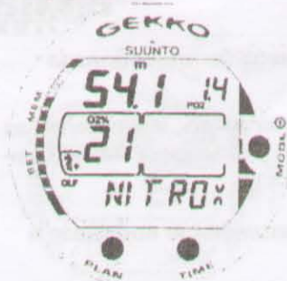
Рис. 3.20 Режим NITROX. Максимальная глубина погружения при текущих параметрах смеси (21% O_2 и 1.4 бар PO_2 ) - 54.1 м.
