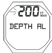
Рис. 41 Установка глубинного сигнала
