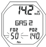
Рис. 37 Установка FO2 GAS2
