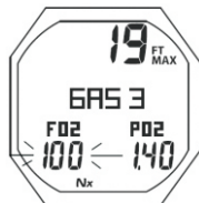
Рис. 38 Установка FO2 GAS3
