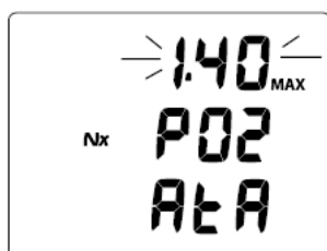
Рис. 30 Установка сигнала PO2
