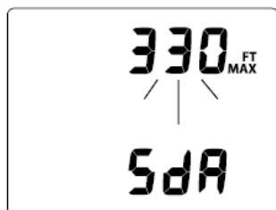
Рис. 24 Установка сигнала глубины
