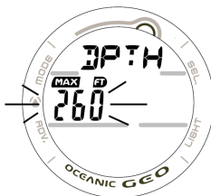
Рис. 42 Установка сигнала глубины
