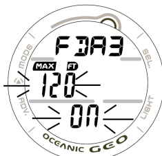
Рис. 106 Установка сигнала 3 глубины
