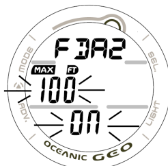
Рис. 105 Установка сигнала 2 глубины свободного погружения
