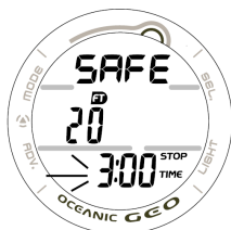
Рис. 49 Установка остановки безопасности
