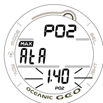
Рис. 46 Установка сигнала PO2
