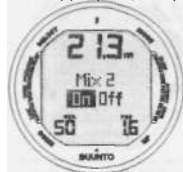
Рис. 5.14. Установка дополнительных ДГС (MIX2, MIX3).
