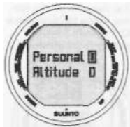
Рис. 5.16. Установка высокогорных и индивидуальных параметров. Нажмите на кнопки прокрутки, чтобы изменить индивидуальный режим. Для подтверждения нажмите S.
