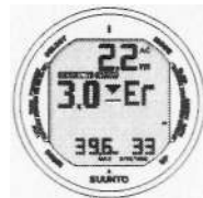
Рис. 6.13. Погружение с декомпрессионными выдержками, выше потолка декомпрессионной остановки. На дисплее появляется стрелка, указывающая вниз. предупреждение об ошибке Eg, раздаются сигналы тревоги. Следует немедленно (в течение 3 мин) спуститься до зоны потолка или ниже.
