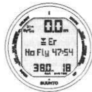
Рис. 6.25. Режим поверхности после нарушения правил декомпрессии. Надпись Eg показывает, что Вы находились выше зоны потолка декомпрессионной остановки более 3 минут. Вы не должны погружаться как минимум 48 часов
