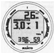
Рис. 6.8. Обязательная остановка безопасности. Вам следует совершить обязательную остановку безопасности в течение 1 минуты в диапазоне глубин 6 и 3 м.
