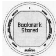
Рис. 6.3. Активация пометки в памяти. Аннотация (Bookmark) записывается в память профиля погружения нажатием кнопки S.
