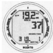
Рис. 6.6. Индикатор скорости всплытия. Звуковые сигналы, подсветка и мигающая диаграмма скорости всплытия показывают, что скорость всплытия превышает 10 м/мин. Водолазу следует снизить скорость! Знак STOP означает, что Вам следует совершить обязательную остановку безопасности при достижении глубины 6 м.
