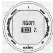
Рис. 5.22 Настройка RGBM. Нажмите up/down, чтобы изменить установки
