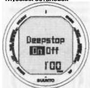
Рис. 5.20 Выбор остановки безопасности/глубокие остановки. Кнопки up/down, для изменения.
