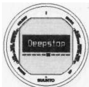
Рис. 5.19. Вход в установки глубоких остановок
