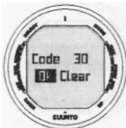
Рис. 5.29 Канал сонастройки 32. Для того, чтобы удалить код, выберите Clear, а для того, чтобы подтвердить - ок.
